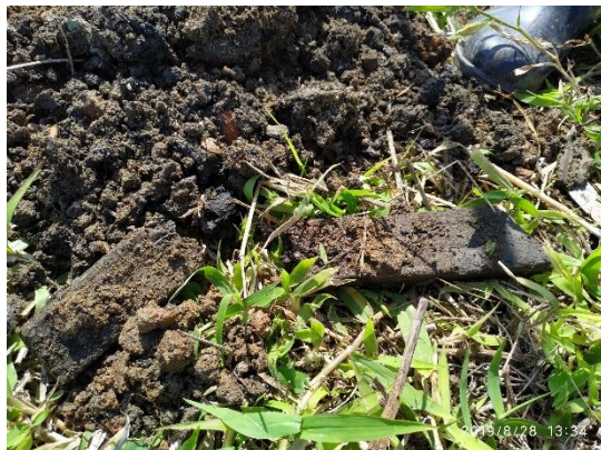
Figura 21 - Registro de estacas de madeira encontradas em sondagens.
